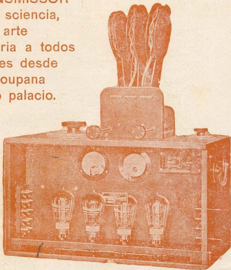
Transmissor de 100 Watts Typo Q. Ondas de 100 a 500 metros.
